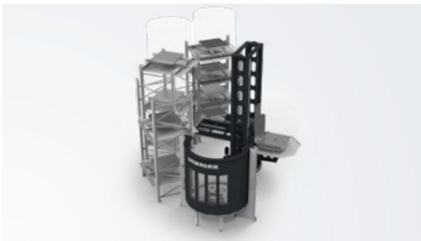
Mit der überarbeiteten Version des Rotationsladesystems RLS präsentieren wir eine leistungsstarke Lösung für die automatisierte Maschinenbeladung – jetzt auch für Werkstücke bis 2.000 kg. Die neue Variante bietet eine höhere Speicherdichte, erweiterte Störkreisdurchmesser (bis 1.400 mm) und maximale Flexibilität bei minimalem Platzbedarf.
